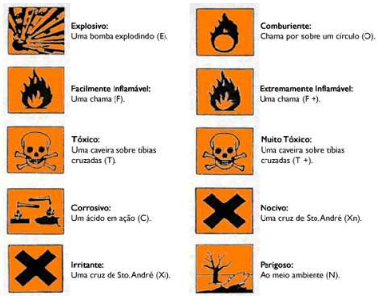
Figura 1: Símbolos de riscos usuais ilustrados em rótulos de reagentes químicos com a indicação dos respectivos riscos.
